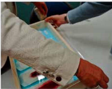
図9 透明メタクリル板装着 (透明テープを使用し開閉ができる)
